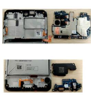
8. Main/Sub PCB Remove
